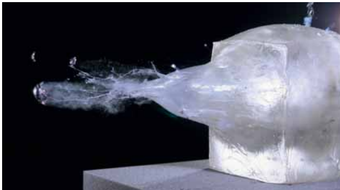
Abbildung 1: Dieses Symbolbild zeigt die terminale ballistische Fragmentierung eines Projektils beim Aufprall auf ein weiches Ziel wie diesen Gelatineblock.
