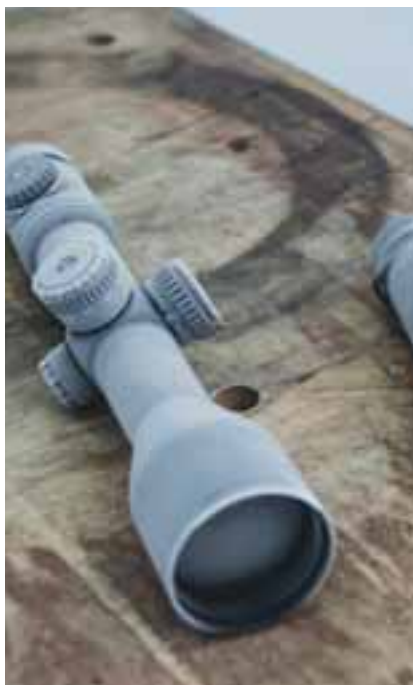
Nach der Kältekammer sind die Optiken mit einer Eisschicht überzogen.
