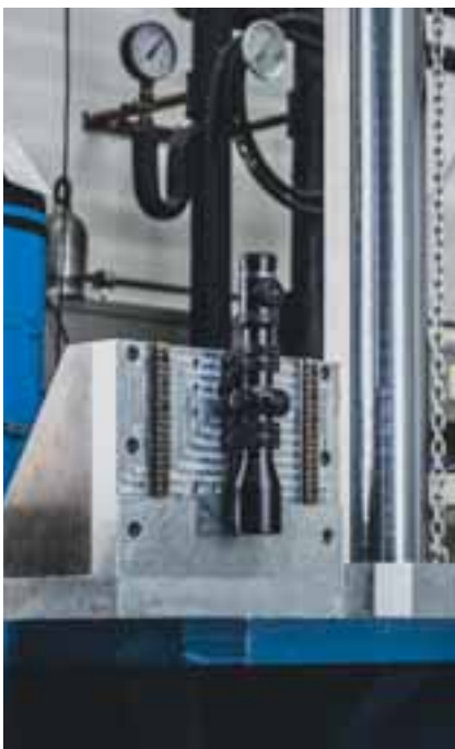
Das V8 bei der Schock-Simulation. Auch nach über 800 Schocks bleibt das Schussbild unverändert.
