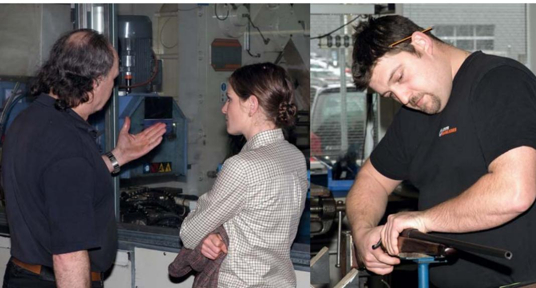
**Bilder links:** Ein Mitarbeiter der Steyr-Werke erklärt den ganzen Vorgang um die kalt gehämmerten Gewehrläufe. Steyr kann hier auf eine grosse Erfahrung zurückblicken. – Die «Hochzeit», also die Verbindung von Lauf und System mit dem Schaft erfordert exakte Handarbeit, denn diese «Vereinigung» muss für eine gute Schussleistung perfekt sein.
